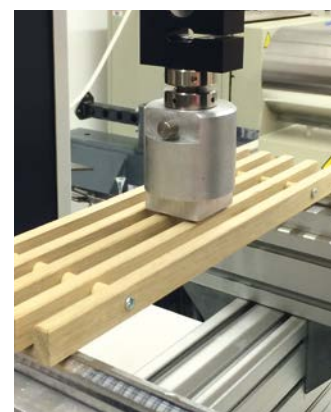
Belastungsprüfung der Lamellen
